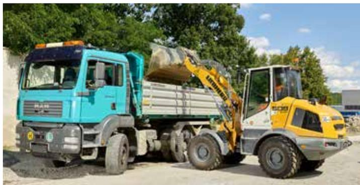
Mit dem kraftvollen hydrostatischen Fahrtrieb erreicht die Speeder-Variante des L 509 eine Spitzengeschwindigkeit von 38 km/h.
